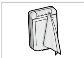
**2** Use una toallita con alcohol para limpiar los electrodos de oro en la espalda.
