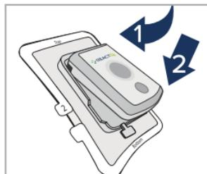
**6** Inserte la Unidad de Control. Inserte la parte superior del colgante, luego presione hacia abajo en la parte inferior.
